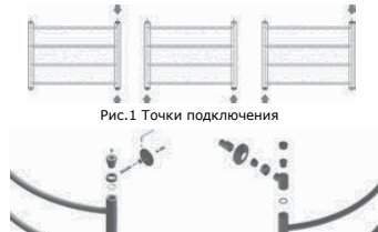
Рис. 1.1 Сборка универсальной заглушки с краном Маевского
